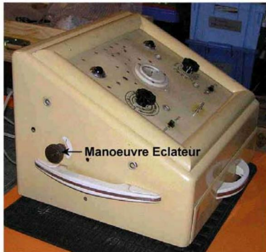
Le panneau de commande ou on voit le réglage de la puissance à droite et le minuteur à gauche, l'ampèremètre au centre.
