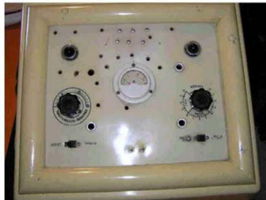
Le panneau de commande ou on voit le réglage de la puissance à droite et le minuteur à gauche, l'ampèremètre au centre.
