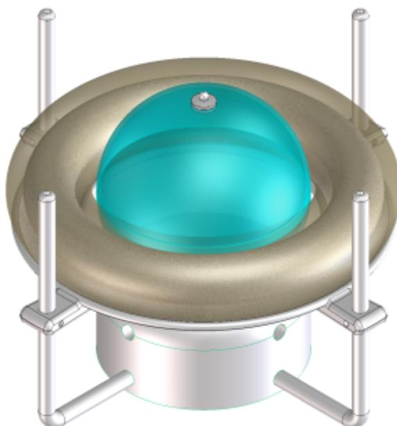
Senzory teploty, magnetického pole a snímače napětí uvnitř komory umožní sledování dosažených podmínek spolu s kamerami. Vše pod kontrolou námi vyvíjeného software **SenseLab**.
