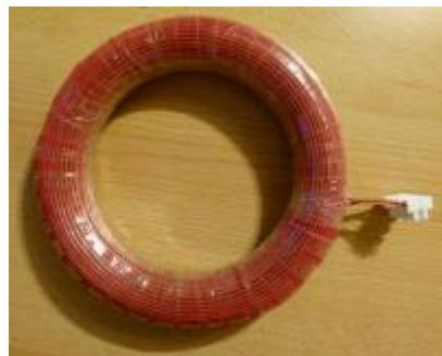
Aby bylo magnetické pole v cívce dostatečně silné, potřebuji dostatečné proudy v ní, ale ne větší než je schopno vydržet vinutí. Jde o pulzy, takže nebude proudit stále v plné síle. Vinutí tedy snese větší proudy, než maximální stejnosměrný proud daného drátu, aby se neroztavil tepelnými
